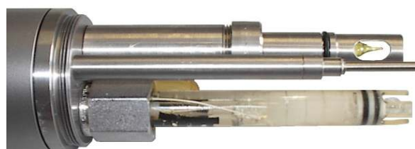
プローブ内の H 2 S, pH, 温度, 深度の各センサー
