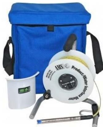
AMS社製簡易油層厚測定器（モデル3012.96）は水面上に浮いた炭化水素と水面下に沈殿した炭化水素の両方（非水溶性の層）の厚さを測定できます。ステンレス製のプローブは外径 5/8”（15.9mm）の細さで小型のため使いやすく、幅広い調査に役立ちます。
